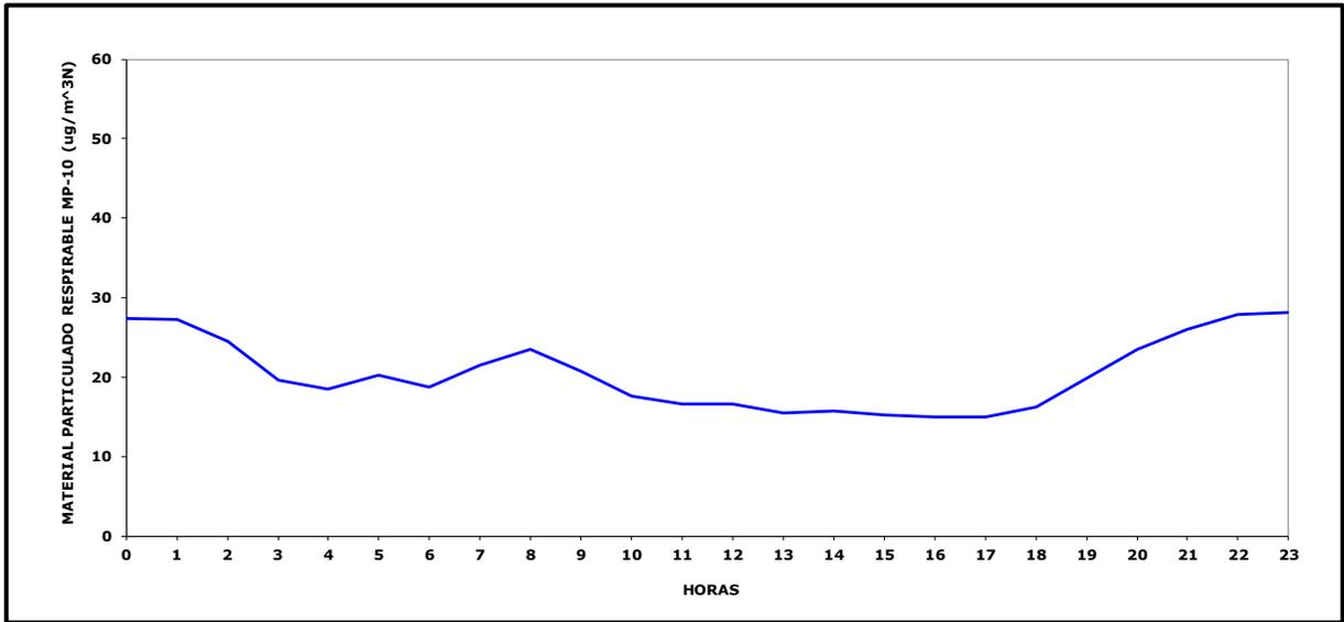
En la estación de monitoreo, la máxima concentración horaria se registró a las 23:00 hrs. La máxima concentración de 24 horas se registró el día 18 de Abril 2024 con un valor de 41 µg/m<sup>3</sup>N. La media del periodo es de 19 µg/m<sup>3</sup>N.
